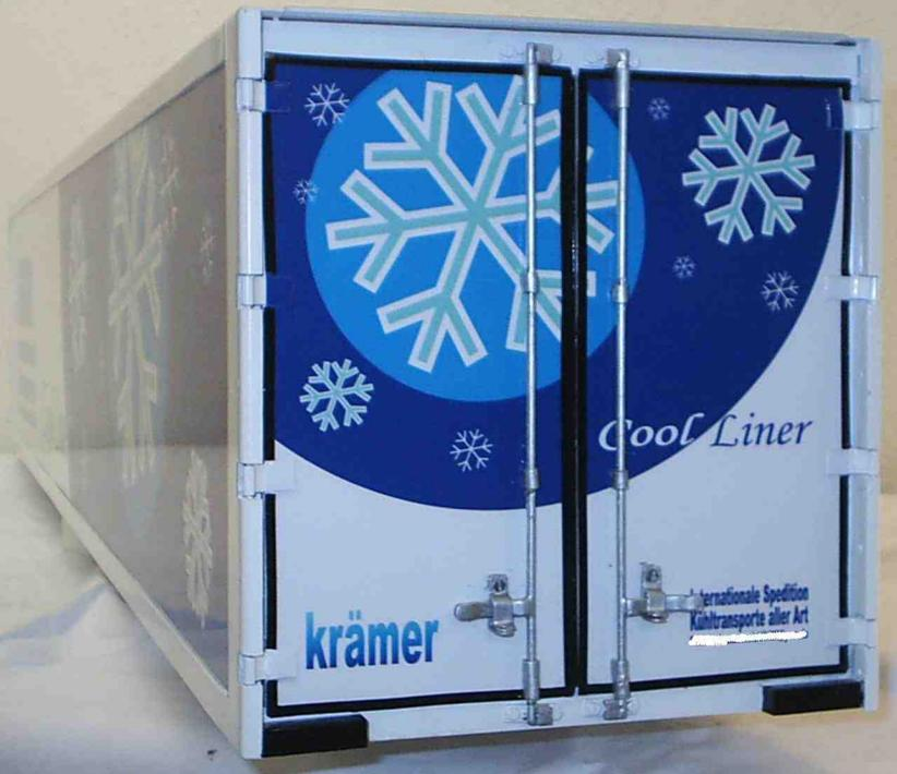
**mit inliegenden Riegelstangen und Türbändern**
